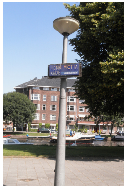
Conische mast met Friso Kramer armatuur Hoogte: 4 meter
