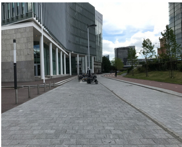
Voetpad: Breccia tegel*, 300x300x80mm Fietspad: 300x300x80mm, kleur. rood, n.t.b.
