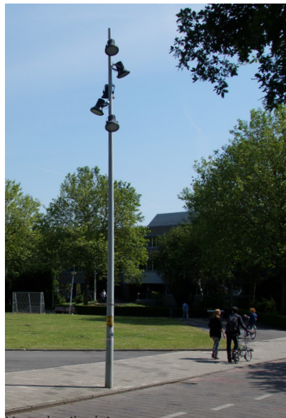
Hergebruik pleinmast Hoogte: 9 m Opnieuw coaten
