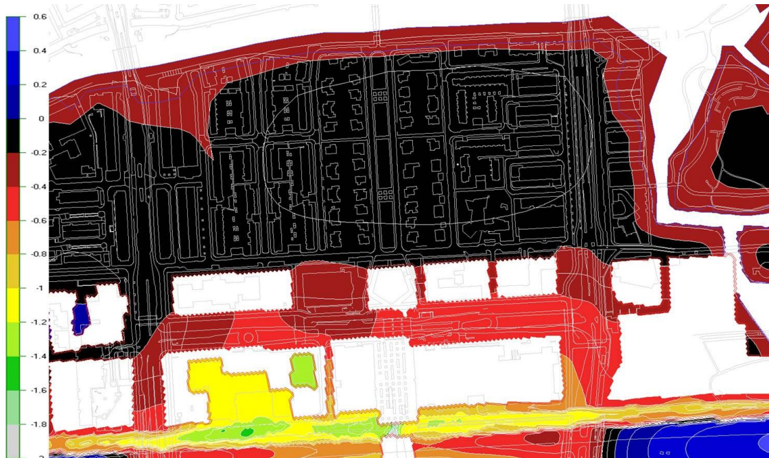
Figuur 13: Berekende maatgevende freatische grondwaterstand in de toekomstige situatie met de ondergrondse fietsenstalling "vijfhoek Minerva-as", ondertunneling ringweg A10-Zuid (Zuidasdok) en de overige ontwikkelingen in de Zuidas (waaronder DT-riool Prinses Irenestraat) [m+NAP]
