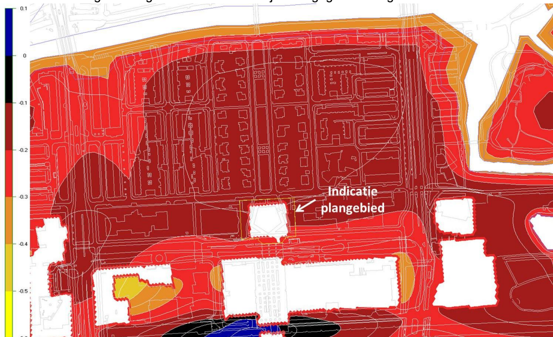
Figuur 9: Berekende maatgevende freatische grondwaterstand na aanleg van de ondergrondse fietsenstalling exclusief eventuele andere ontwikkelingen in de omgeving [m+NAP]
